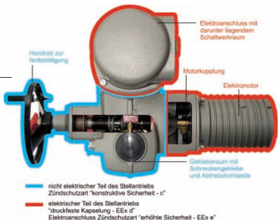
1: Elektrischer und nichtelektrischer Teil bei einem Drehantrieb der Baureihe SAExC
