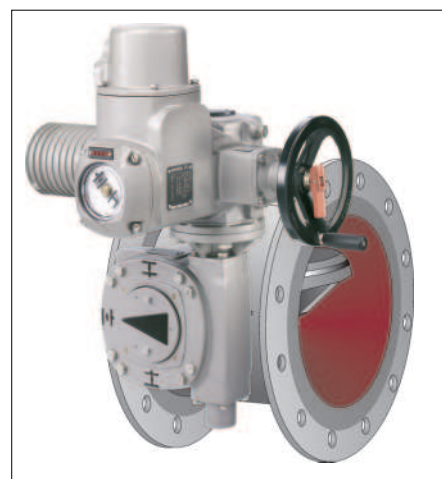
Bild 5: Drehantrieb SA 07.5 kombiniert mit Schwenkgetriebe GS 80.3; max. Abtriebsmoment je nach geforderter Lebensdauer bis zu 2 000 Nm, Stellzeiten für 90° von 9 s – 100 s
